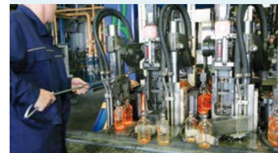
Herstellung von Glasflaschen an einer IS-Maschine
